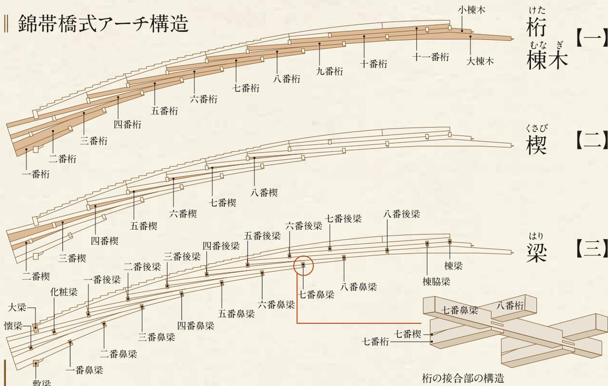
上の図はアーチ橋（橋脚から中央まで）の側面。橋を下から見上げた写真（左）において、縦に走る5本の桁を、真横から見た図です。
